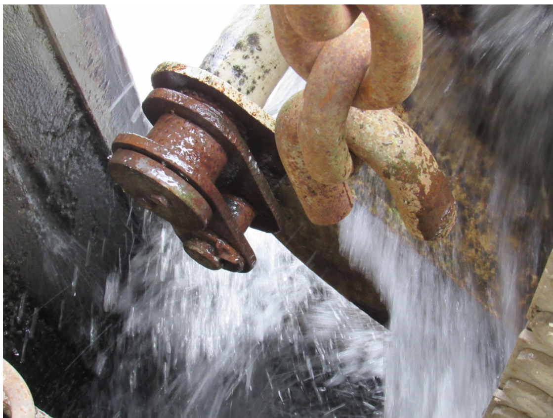
Dolní závěs článkového řetězu – přetržené koncové oko
