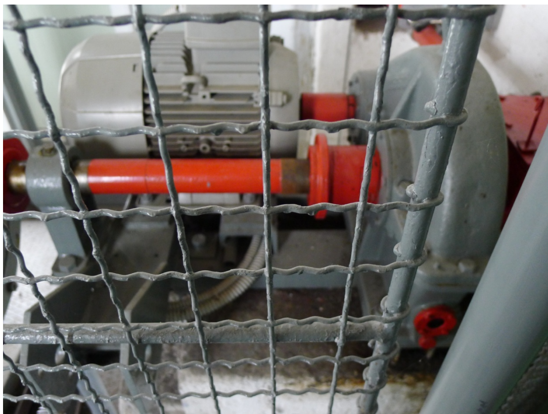
Čelní převodovka s elektromotorem
